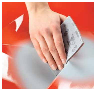
Záverečné brúsenie na plniči v ťažko prístupných miestach
